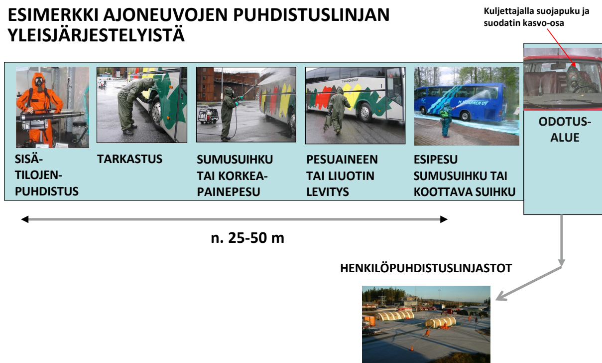
Kaavio 9. Esimerkki ajoneuvojen puhdistuslinjan yleisjärjestelyistä.
