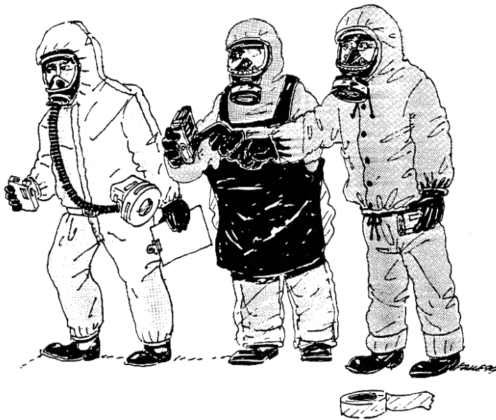
Kuva 5. Neste- ja roisketiivis kemikaalisuojapuku.
