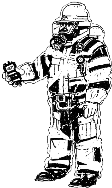
Kuva 4. Paloasu ja paineilmalaitte täydennettynä tyypin 4 tai 6 roisketiiviillä kemikaalisuojapuvulla
