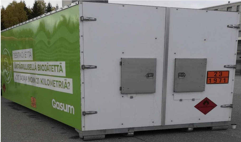
Kuva 4. MEG-kuljetuskontti maassa. Kuvassa takapäätty, josta löytyy myös käyttökeskus.
