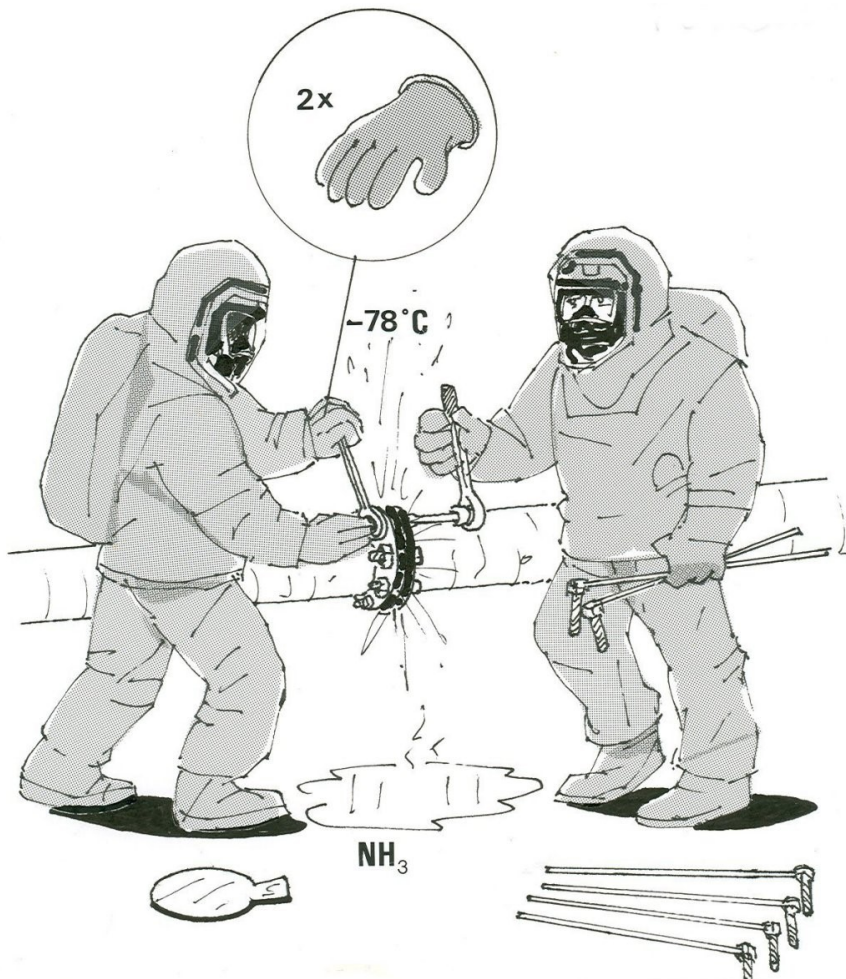
Kuva M9. 6. Laipan kiristäminen
