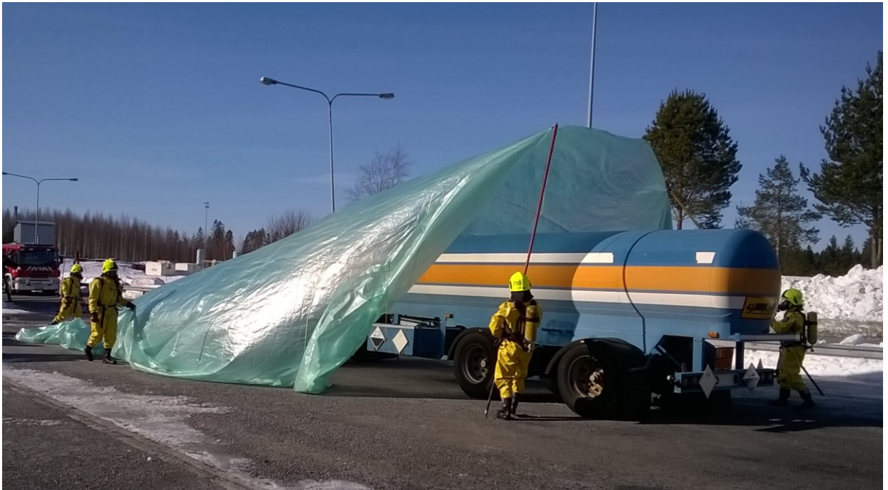
Kuva M8a. 4. Rikkidioksidin maantiekuljetussäiliön peittäminen, kun vuotokohta on säiliövaunun päällä.
