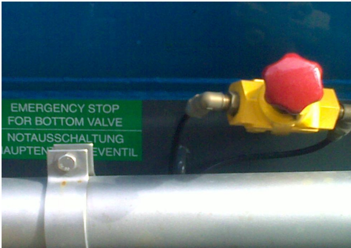
Kuva M6e. 3. Pohjaventtiilin hätäsulku on ajoneuvon molemmilla sivuilla
